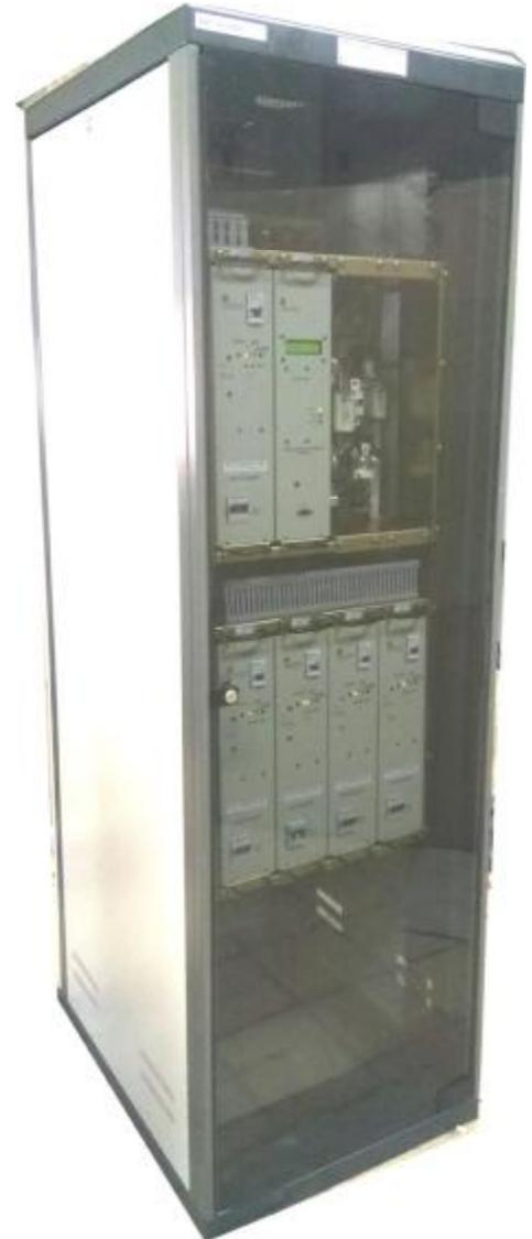
**V001:** Apto para cargar bancos de batería de PbAC, selladas o abiertas, de 1800 Ah. La salida de consumo es doble, una de 140 A protegida por fusible NH de 160 A y corte por batería baja, y otra de 25 A protegida por llave Termomagnética de 63 A sin corte por batería baja.
